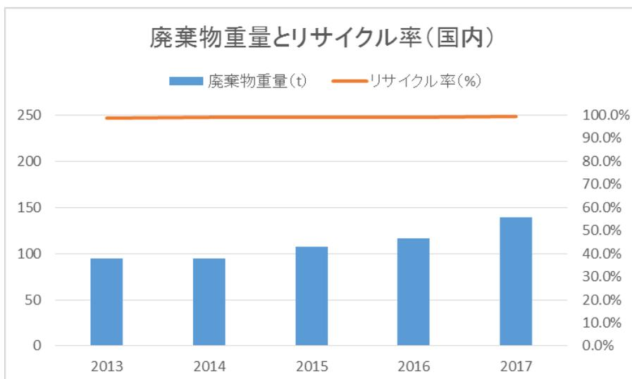
排水汚泥は道路の路盤材としてマテリアルリサイクルされ、廃溶剤は燃料としてサーマルリサイクルされています。
